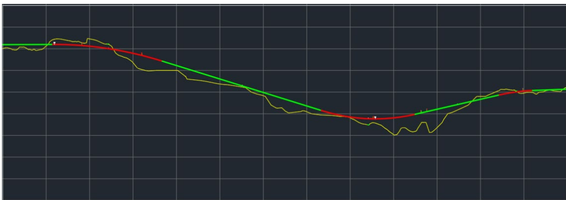
Figur 22: Plantegning av vegtrasé lagt med kurve (øverst), med lengdeprofil (nederst). I lengdeprofilet illustrerer gul linje dagens topografi, mens rød og grønn linje illustrerer planlagt vegtrasé. Inngrepet krever lite ekstra masser. (Kilde: Sweco Norge AS)
