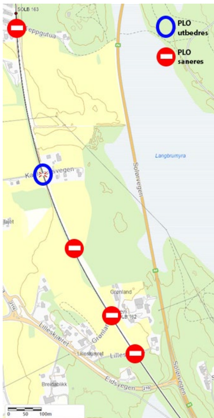
Figur 6: Oversikt over eksisterende planoverganger. Midterste punkt er allerede sanert. (Kilde: Bane NOR banekart, 2024).
