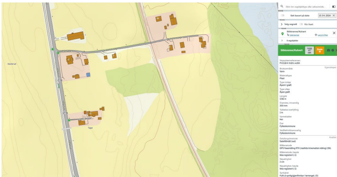
Figur 28: Registrert kulvert/stikkrenne Ø300 mm vest for planområdet. Denne vil bidra til å senke vannlinjen ved flom.
