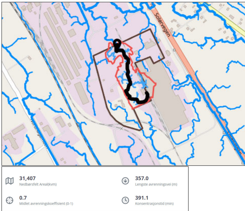
Figur 4: Beregning av konsentrasjonstid i feltet. Avrenningsvei er vist med sort linje. Flomkuben, 7analytics.
